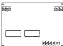
Le module de réception sans fil PC5132-900 peut être utilisé pour relier jusqu'à 32 dispositifs sans fil. Tous les dispositifs sont à spectre étalé, 900 MHz, entièrement supervisés et utilisent des piles alcalines standard 'AAA' ou 'AA' (Reportez-vous à la section 5.27, «Extension sans fil»). (Voir le Manuel d'Installation du PC5132.)
