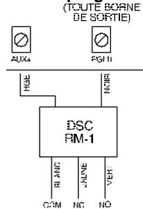
Chaque sortie PGM est un collecteur ouvert de mise à la terre. C'est-à-dire, lorsqu'une sortie PGM est activée par le panneau, la borne passe à la terre.
