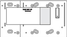
Cette plaque arrière est utilisée lorsqu'un poste audio doit être situé près d'un clavier. Dimensions approximatives de 208 mm x 115 mm x 7 mm / 8,2 po x 4,5 po x 0,25 po.
