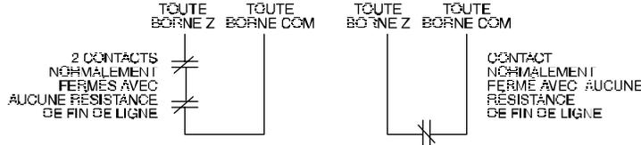
Pour activer les Boucles normalement fermées, section de programmation [013], option [1] doivent être ALLUME.
