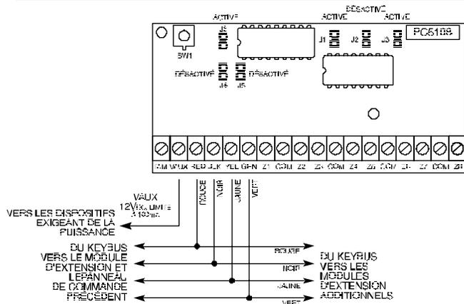
Dans le diagramme ci-dessus, les réglages des fils de connexion illustrés indiquent que le premier groupe de quatre zones de l'extenseur se compose des zones 9 à 12 et que le second groupe de quatre zones comprend les zones 13 à 16. Il est possible de désactiver un groupe de zones si ces dernières ne sont pas requises lors de l'installation.
