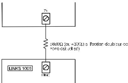
Si le communicateur cellulaire LINKS1000 est utilisé, une zone peut être configurée en tant que zone de réponse LINKS afin de permettre le téléchargement en cas de panne de la ligne téléphonique.
