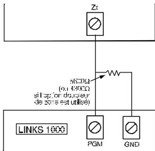
Si le communicateur cellulaire LINKS1000 est utilisé, une zone peut être configurée en tant que zone de supervision LINKS. Programmez cette zone comme zone type [09], 24 Heures Surveillance en section [001].
