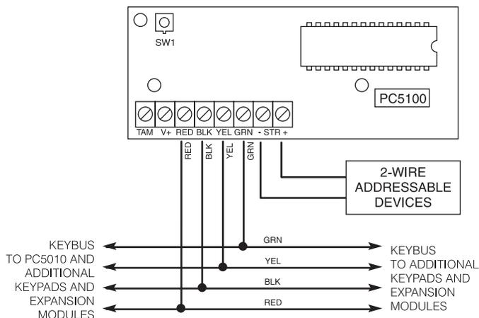
Le PC5100 permettra aux dispositifs de boucle multiplex adressable d'être ajouté au système. Ces dispositifs utilisent une connexion 2-fil pour alimenter et pour communiquer avec le panneau de contrôle. Ceci, en combinaison avec le dispositif de courant faible, simplifie le câblage et le nombre de dispositif pour installation rapide et efficace.
