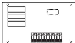
Le PC5204 peut fournir jusqu'à 1 amp. de puissance additionnelle aux modules ou dispositifs reliés au panneau de commande. Le module requiert un transformateur de 16,5 V et de 40 VA, ainsi qu'une pile de 4 Ah. En outre, le module fournit quatre sorties programmables à haute intensité. Chaque sortie est programmable individuellement et est dotée de 19 options de sortie différentes. (Reportez-vous à la section 5.10, «Sorties PGM»)(voir la Feuille des Instructions d'Installation du PC5204)
