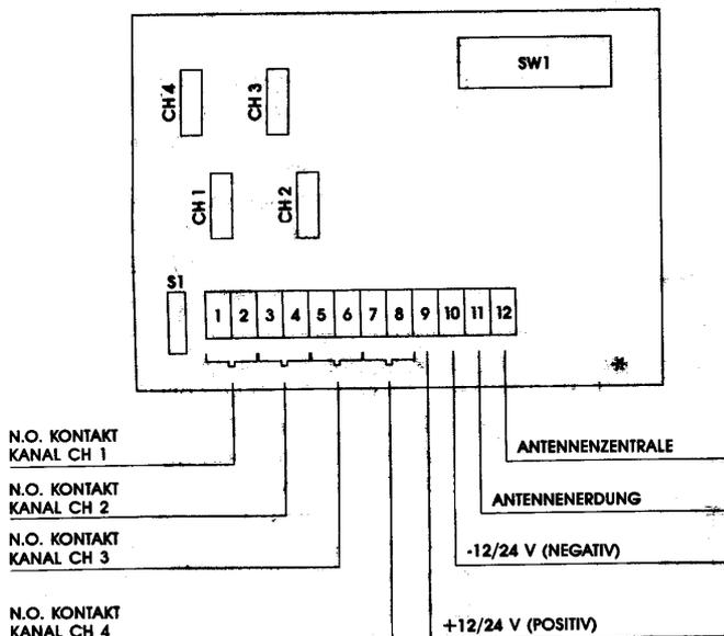
DER KANAL CH 1 ENTSPRICHT DER ERSTEN TASTE DER SENDE.
