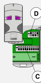
impostare il codice sul dip-switch C e il canale su D (P1=CH1 e P2=CH2, impostazione di default)
