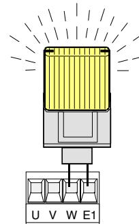
**Collegamento elettroserratura (12V -15W max.)**
