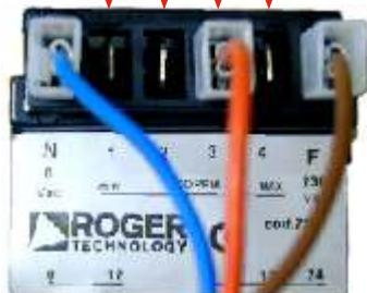
Le réglage de la puissance moteur se fait directement sur l'auto-transformateur.
