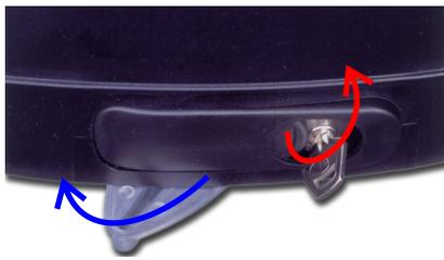
Le débrayage des moteurs se fait en tournant la clé dans le sens contraire des aiguilles d'une montre et en tirant la poignée située sous le moteur.
