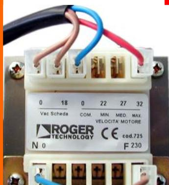
Le réglage de la vitesse du moteur se fait directement sur l'auto-transformateur.
