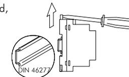
El transformador puede instalarse en guía DIN (3 elementos), realizando una leve presión. Para sacar el transformador de la guía utilizar un destornillador plano y hacer palanca, tal y como muestra el dibujo.
