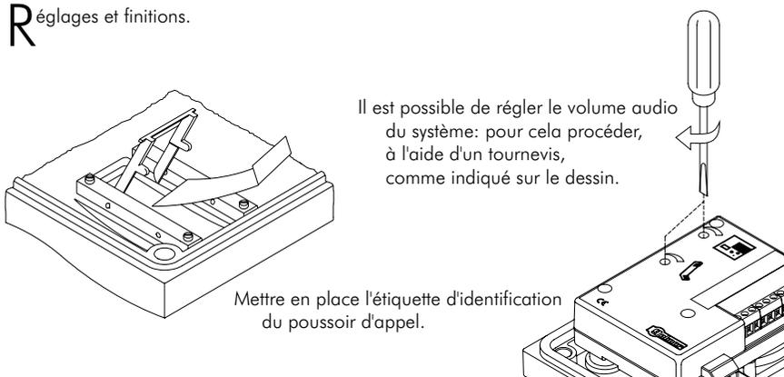
Il est possible de régler le volume audio du système: pour cela procéder, à l'aide d'un tournevis, comme indiqué sur le dessin.
