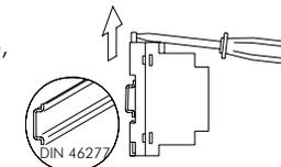
Pour une fixation sur rail DIN 46277, exercer une légère pression jusqu'à l'emboîtement de celui-ci. Pour le retirer du rail, utiliser un tournevis plat et effectuer un mouvement de levier comme indiqué sur le schéma ci-joint. Le transformateur TF-104 équivaut à 3 éléments DIN.
