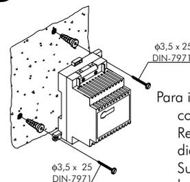
Instale el transformador en un lugar seco y protegido. Recuerde que la normativa vigente obliga a proteger el transformador con un interruptor magnetotérmico.
