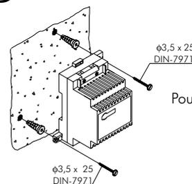
Installer le transformateur dans un endroit sec et protégé. Son alimentation devra être protégée en tête de ligne par un disjoncteur/interrupteur différentiel 30mA et comporter une mise à la terre.
