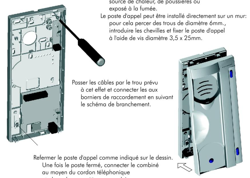
Passer les câbles par le trou prévu à cet effet et connecter les aux borniers de raccordement en suivant le schéma de branchement.
