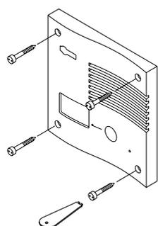
Fixer la plaque de rue au boîtier d'encastrement au moyen des vis fournies et à l'aide de la clé.
