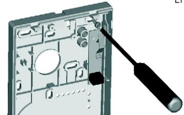
Pasar los cables de la instalación por el orificio dispuesto a tal efecto, y conectarlos a la regleta según los esquemas de instalación.
