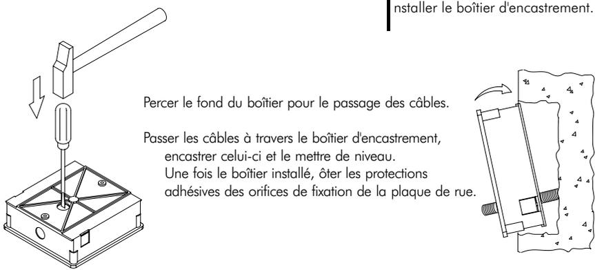
Percer le fond du boîtier pour le passage des câbles.
