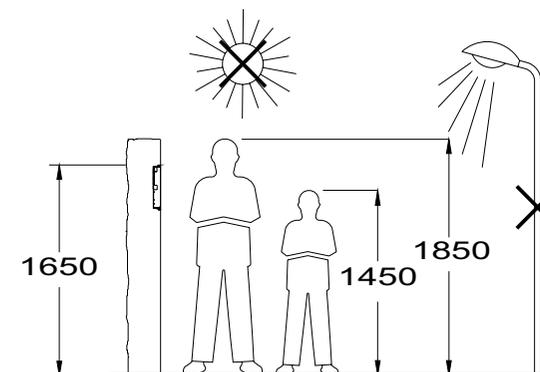
Percer un trou dans le support où l'on souhaite installer la plaque de rue, à une hauteur de 1,65m. Les dimensions du trou sont:
